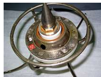
Tête de paratonnerre radioactif
